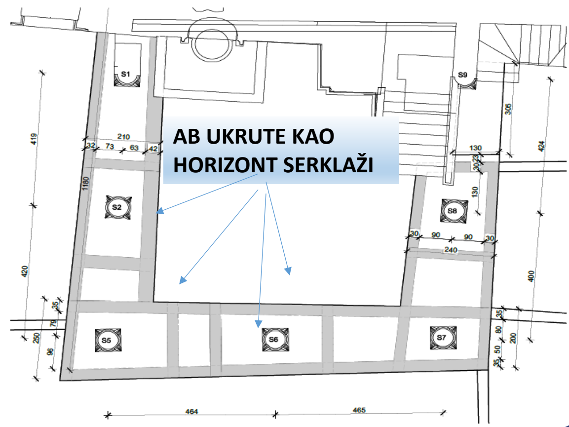
TLOCRT U PRIZEMLJU ATRIJA SA IZVEDENIM AB UKRUTAMA POSLIJE POTRESA IZ 1979.
