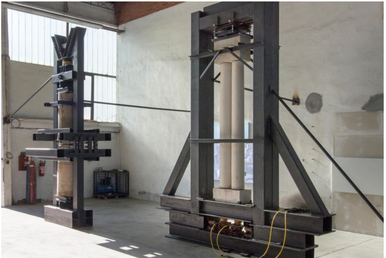
Modelsko ispitivanje stupova prizemlja i kata
