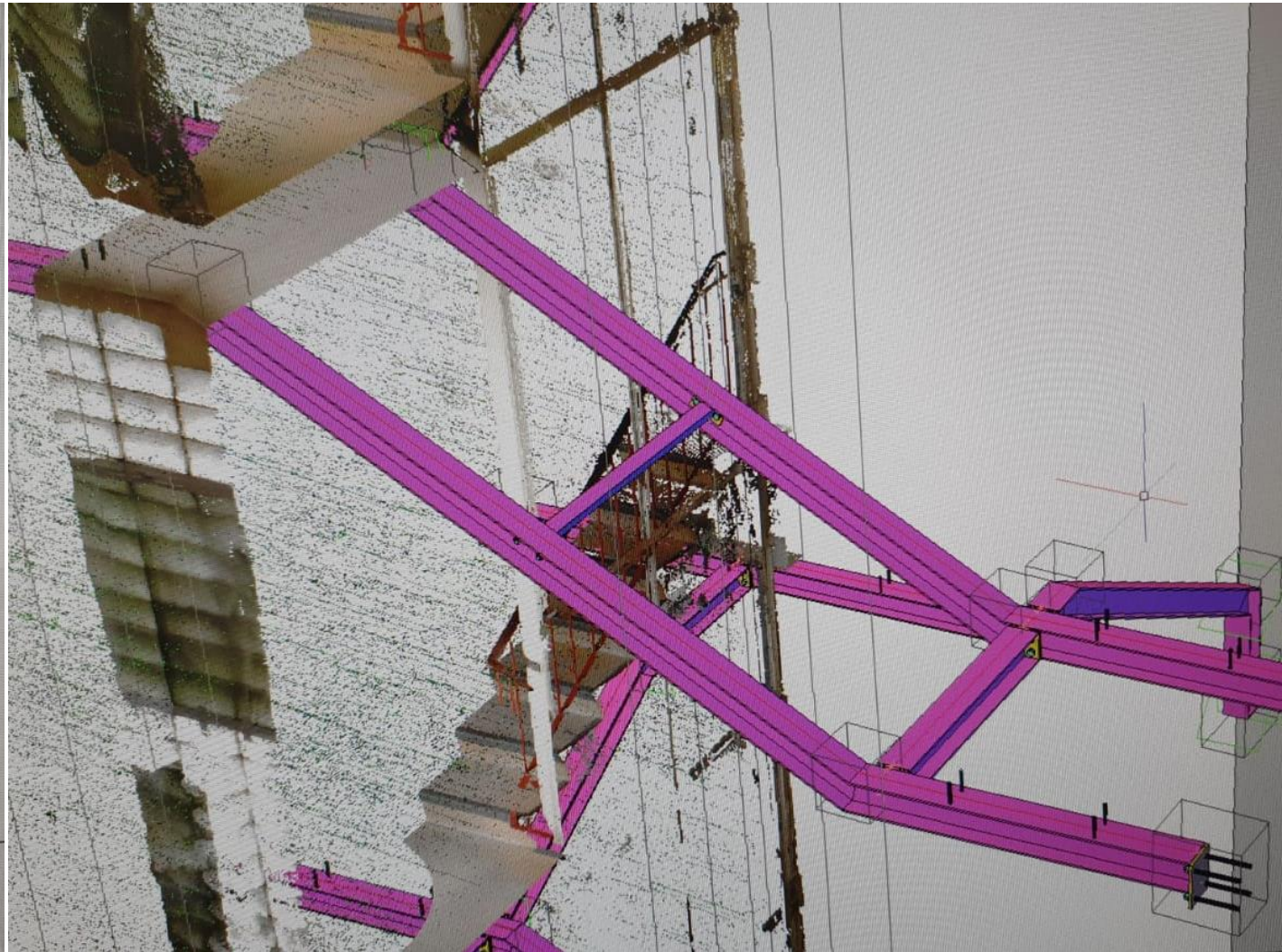
Izvadak iz 3D modela – Advance steel s oblakom točkica od snimanja FARO 3D scannerom (Audodesk ReCap datoteka)
