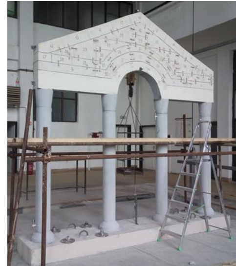
Model konstrukcije Protiron: (a) geometrijske karakteristike; (b) fizikalni model
